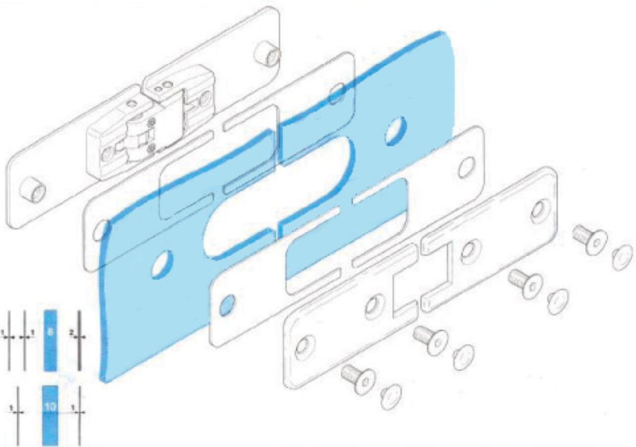
1/ ajuster et maintenir la porte en position fermée jusqu'au serrage final
