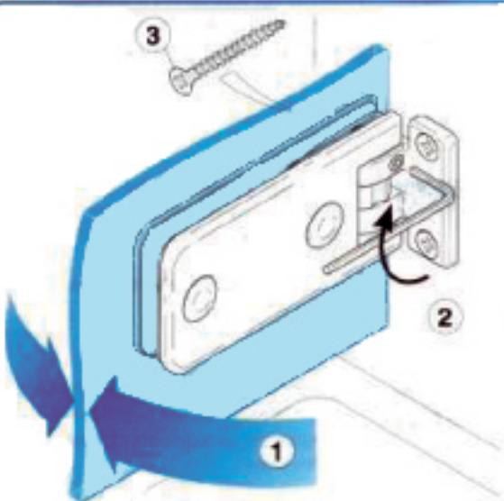
1/ ajuster et maintenir la porte en position fermée jusqu'au serrage final
