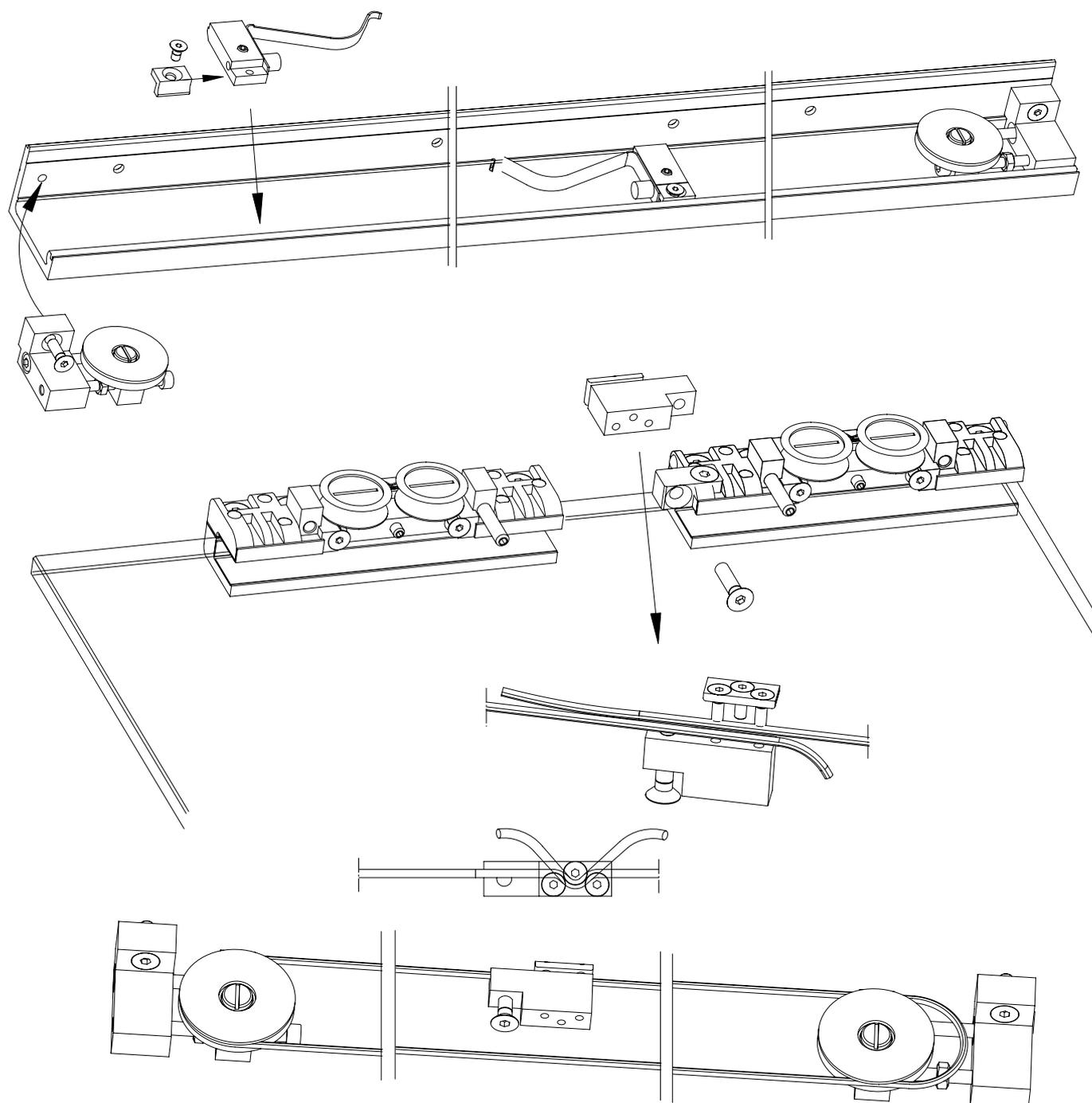
**6. Einhängen der Schiebetüren und Befestigen der Laufschiene**
