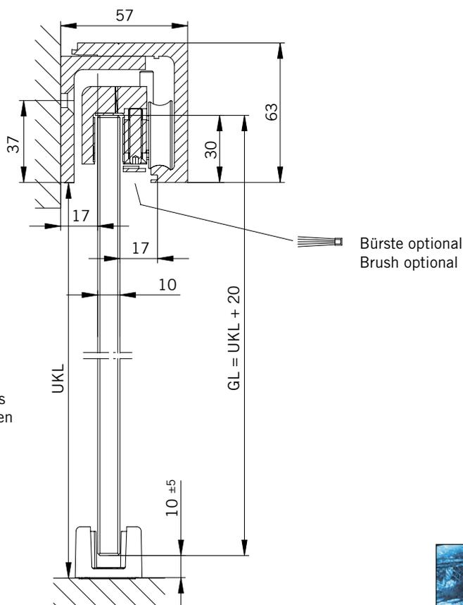
UKL = Unterkante Laufschiene bis Oberkante fertiger Fußboden
