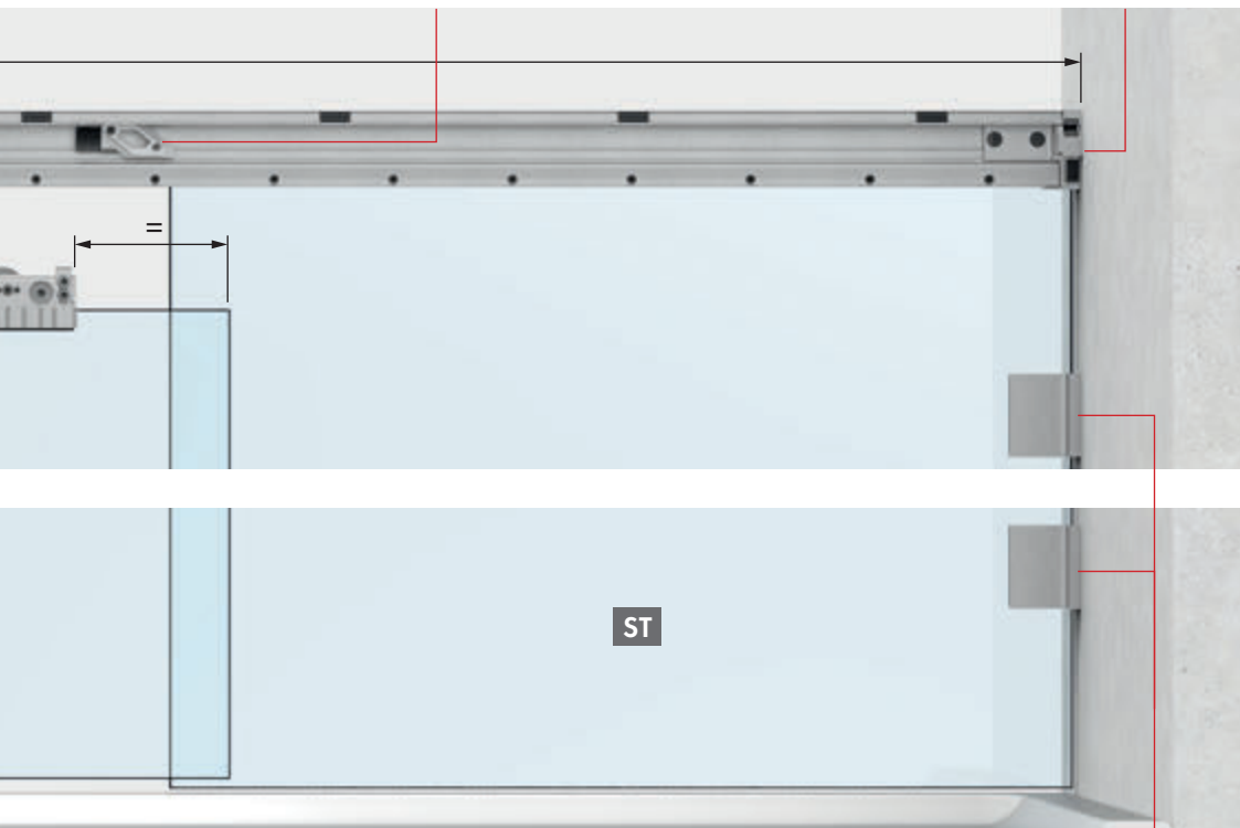
Türanschlag in der Laufschiene door-stop in the guide rail Art.-Nr.: | art no.: 8822ZN_-EA
